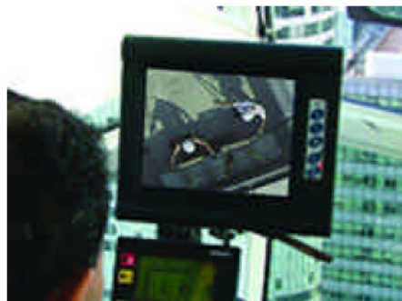
El zoom de la cámara proporciona una visibilidad mayor sobre la carga. Mejoran las condiciones de trabajo del operario y la operación con la grúa es más rápida y segura.
