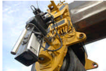
El sistema de cámara con zoom de Eurosealand, al ser inalámbrico es de fácil instalación.
