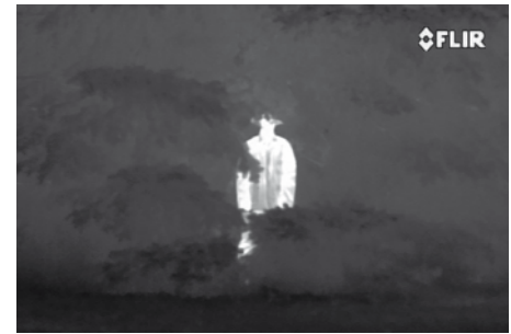
Termografía: un sospechoso escondido entre los arbustos puede verse con claridad ya que el contraste térmico es prácticamente imposible de enmascarar.
